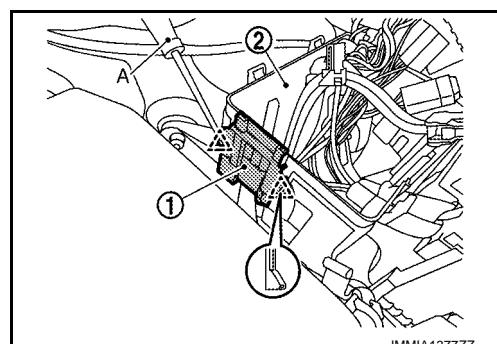
6. 拆下 IPDM E/R 盖 C 装配螺母 ④ 和装配螺栓 ⑤，然后拆下 IPDM E/R 盖 C ①。
