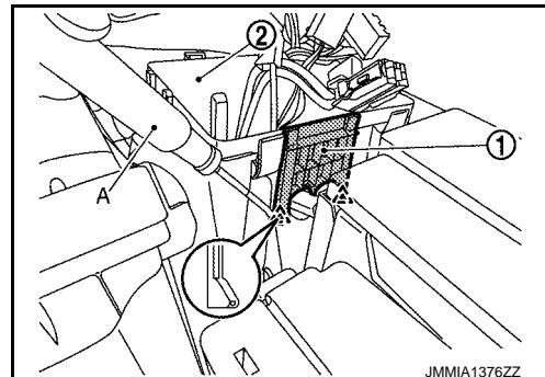
5. 在 IPDM E/R 盖 A ① 和 IPDM E/R 盖 C ② 之间插入拆卸工具 (A)，分开棘爪，然后拆下 IPDM E/R 盖 A。
